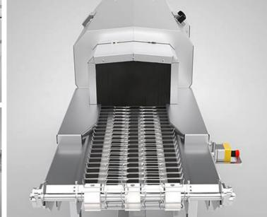
Das Hygienic-Design mit Split-Technologie ermöglicht eine komplette Bestrahlung von allen Seiten und eine wirkungsvolle Beseitigung von unerwünschten Mikroorganismen auf Oberflächen.
